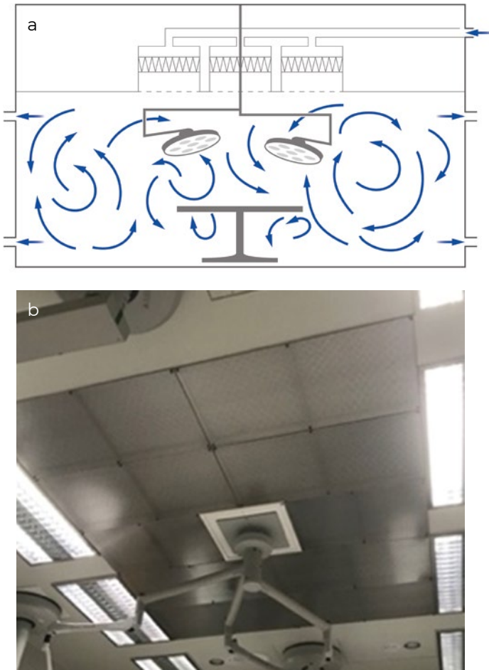
Figuur 1 Werkingsprincipe (a) en foto (b) van een CV-systeem.
